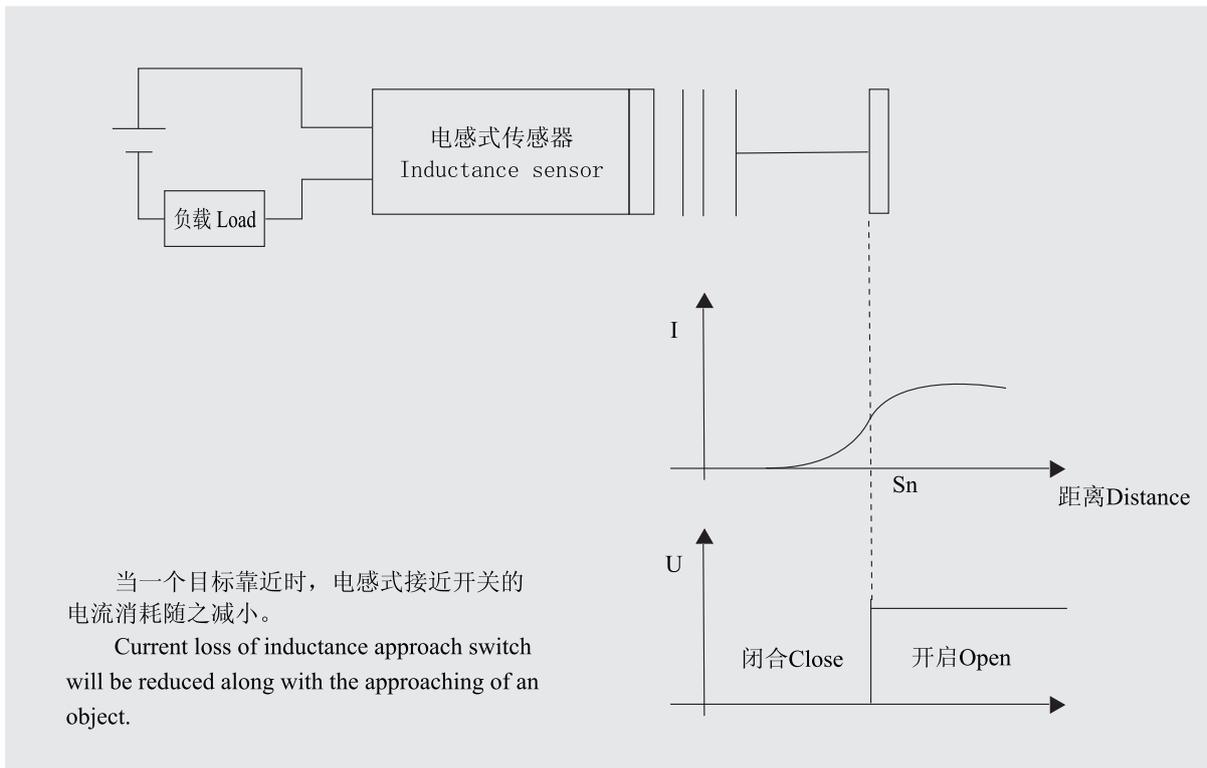
当一个目标靠近时，电感式接近开关的电流消耗随之减小。
