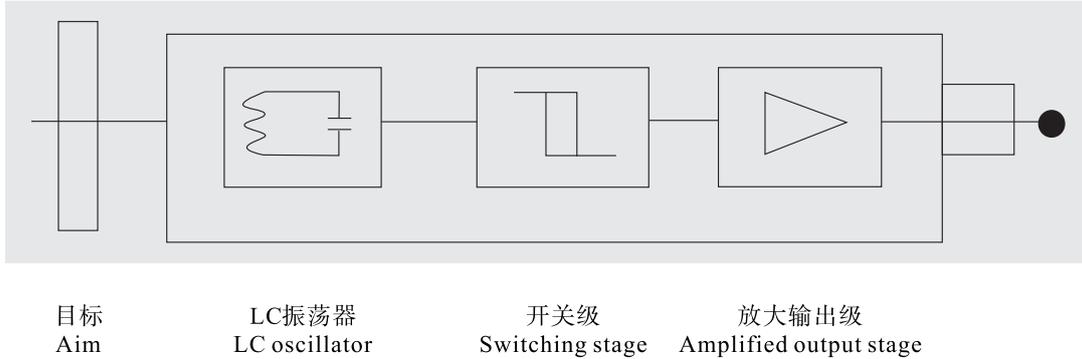
电感式接近开关由三大部分组成：振荡器，开关电路、放大输出电路。振荡器产生一个交变磁场。当金属目标接近这一个磁场时，在金属目标内产生一个涡流，从而导致振荡衰减，以至停振。
