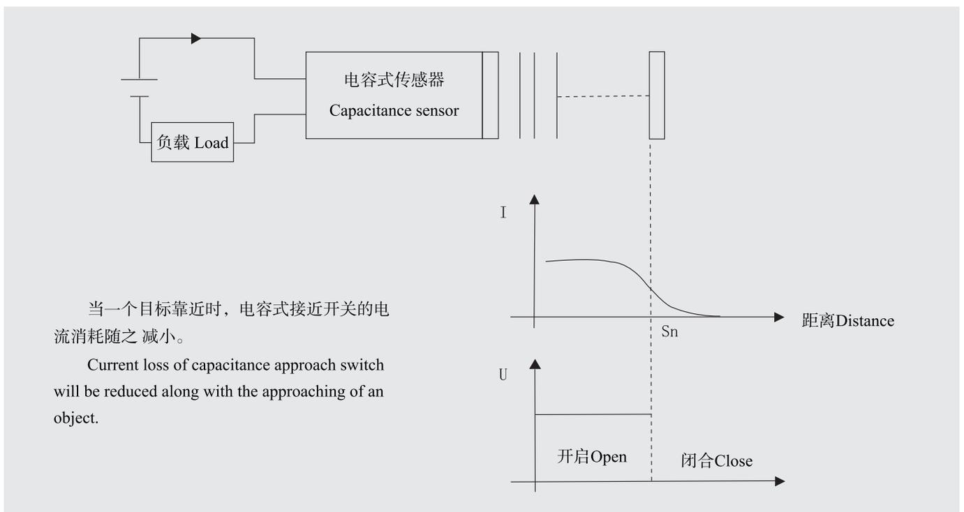
当一个目标靠近时，电容式接近开关的电流消耗随之减小。
